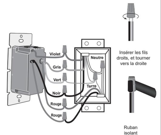
**Raccorder les fils conformément au SCHÉMA DE CÂBLAGE 3 (page 2), en procédant comme suit.**
