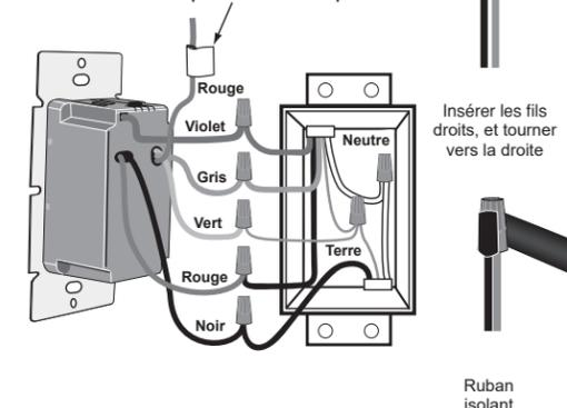
**Raccorder les fils conformément au SCHÉMA DE CÂBLAGE 1 (page 2), en procédant comme suit.**
