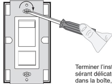
Terminer l'installation en insérant délicatement les fils dans la boîte, en prévoyant suffisamment d'espace pour le dispositif. Installer ce dernier au moyen des vis de montage fournies. Fixer la plaque.
