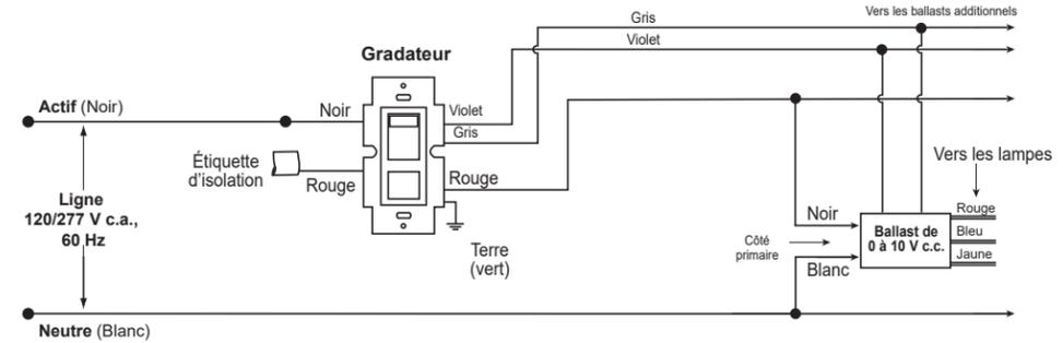
**Schéma de câblage 2 : commande d'un seul emplacement avec des blocs de commutation SP20-RD4**
