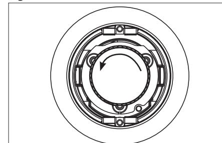
4. Enchufe el conector anaranjado del módulo LED ML4 (A) al conector anaranjado en el adaptador de la base con rosca (B) (Figura 5).
